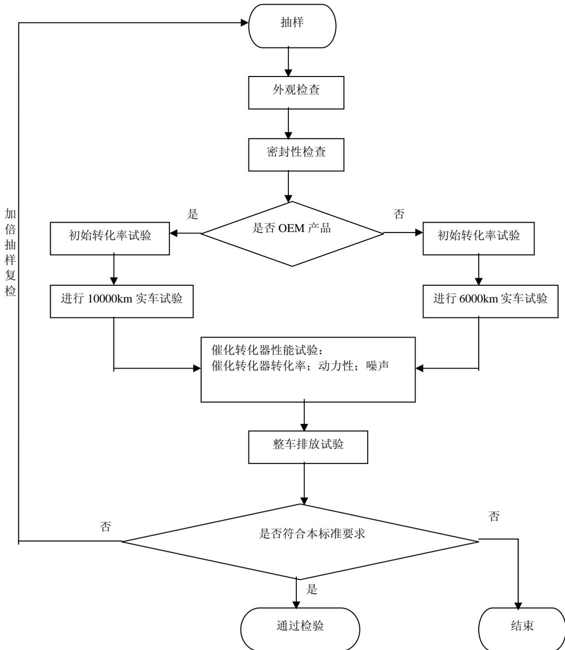
图 1 催化转化器试验程序图
